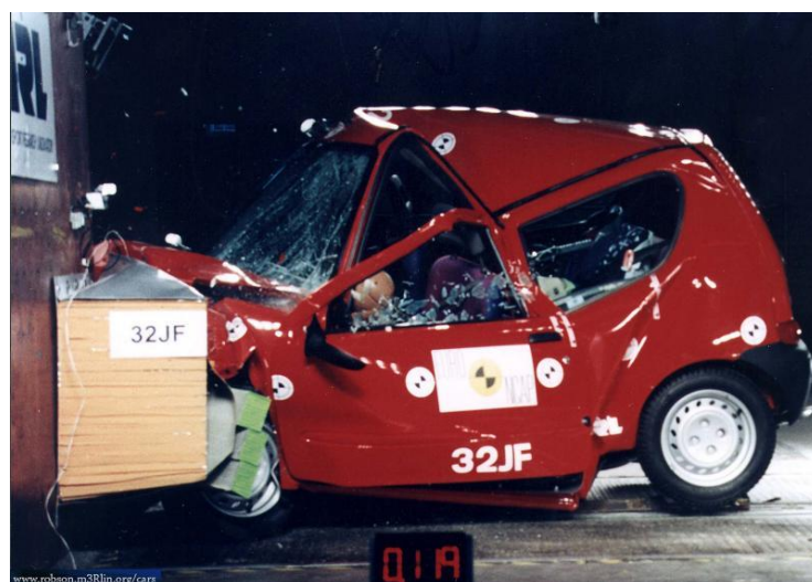
Figure 21 : Exemple d'une voiture mal conçue pour les accidents frontaux: l'habitacle se déforme complètement sous le choc.
