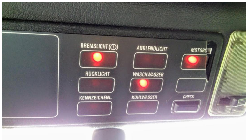
Figure 34 : Ordinateur de bord présent dans une BMW E30 en 1988. Il indiquait déjà à l'époque, par exemple, un défaut d'ampoules de frein, un défaut des phares avant ou arrière, un manque d'huile, un manque de liquide lave-glace, etc...
